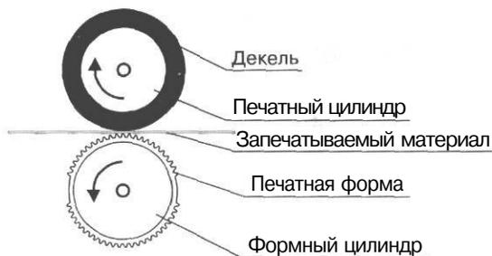
Рис. 6.5. Ротационная машина
